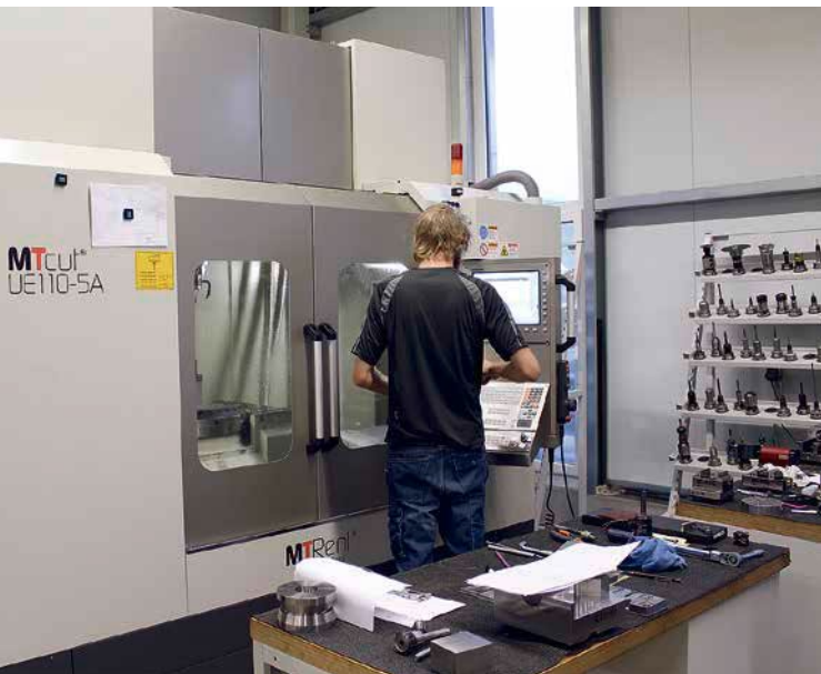
Mit dem 5-Achs-Universalbearbeitungszentrum MTcut UE110-5A mit Frässhwenkkopf und Drehtisch startete der Lohnfertiger seine Produktion.
