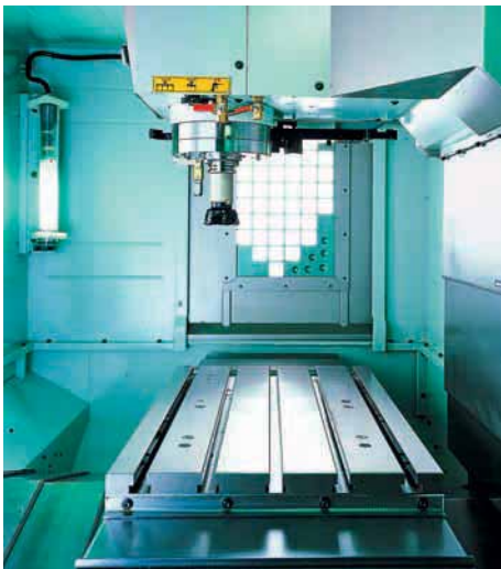
Die 3-achsigen Versionen des Vertikalzentrums lassen sich durch eine Dreh- und eine Schwenkachse zum 5-Achsen-Zentrum aufrüsten
