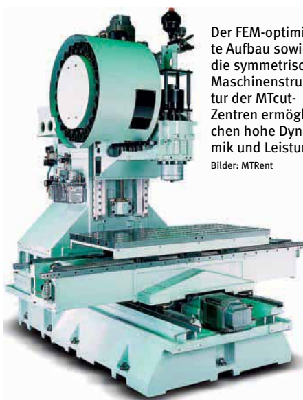
Die 3-achsigen Versionen des Vertikalzentrums lassen sich durch eine Dreh- und eine Schwenkachse zum 5-Achsen-Zentrum aufrüsten
